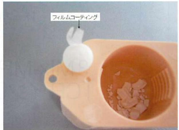
図4 糖衣が砕け、フィルムコーティングが現れたら、メスの刃で剥ぎ取る。
